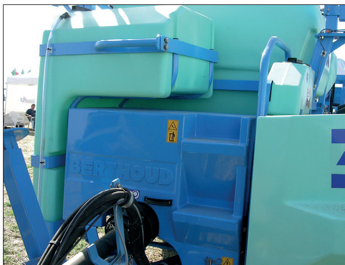
La cuve de rinçage doit avoir un volume au moins égal à 10% du volume de la cuve du pulvérisateur.
