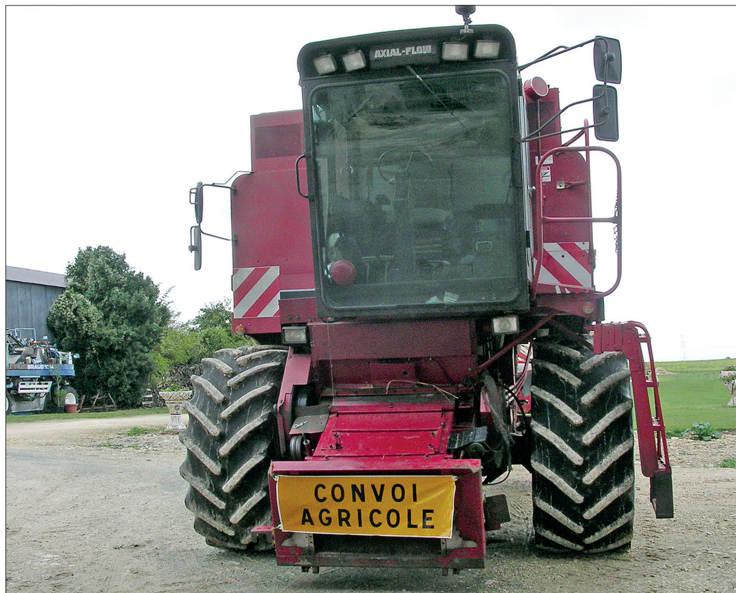
Une voiture pilote est obligatoire à partir de 3,5 m de large.
