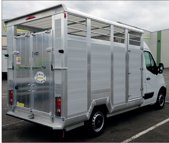
Le véhicule transportant les animaux doit présenter un plancher solide, non glissant, sans aspérité, et une litière pour l'absorption des déjections.
